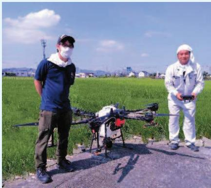
折込みチラシ等で募集を行い、今年度、北井上支所では、35件で約27㌶。南井上支所では18件で、約10・6㌶の作業の委託がありました。ウンカ、カメムシ等の対策として、株式会社三協商事のオペレーターが手動操縦するドローン（機種：MG-1P）により、スタークルメイト液剤の散布をしました。
